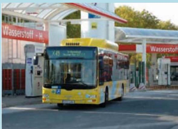
Berlino, stazione di rifornimento di idrogeno: con un processo di *reforming* il GPL, utilizzato come materia prima, viene trasformato in idrogeno. La struttura nasce da un progetto del 6° Programma Quadro Europeo sulla Ricerca finanziato dalla Commissione Europea.
